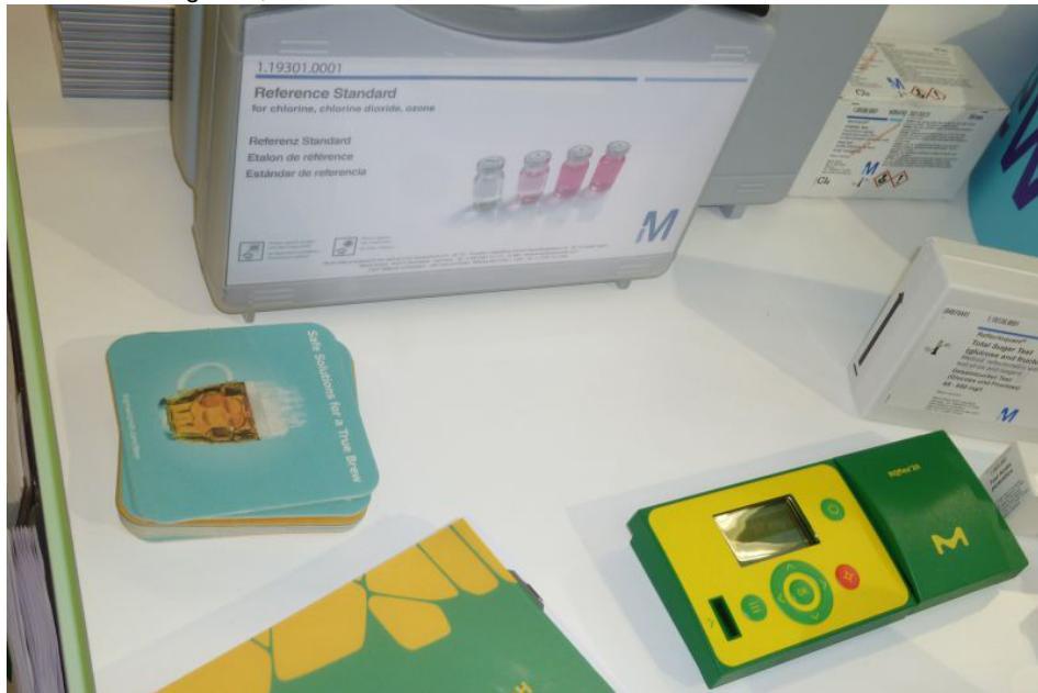
Das Reflektometer »RQflex 20« (rechts unten) ist Teil des mobilen Labors. Bild: Kuhn
