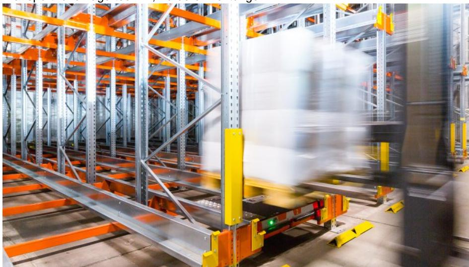
Die semiautomatische Lagerlösung ist eine wirtschaftliche Alternative zum Einfahr-, Einschub- oder Paletten-Durchlaufregal (Bild: Dexion).
