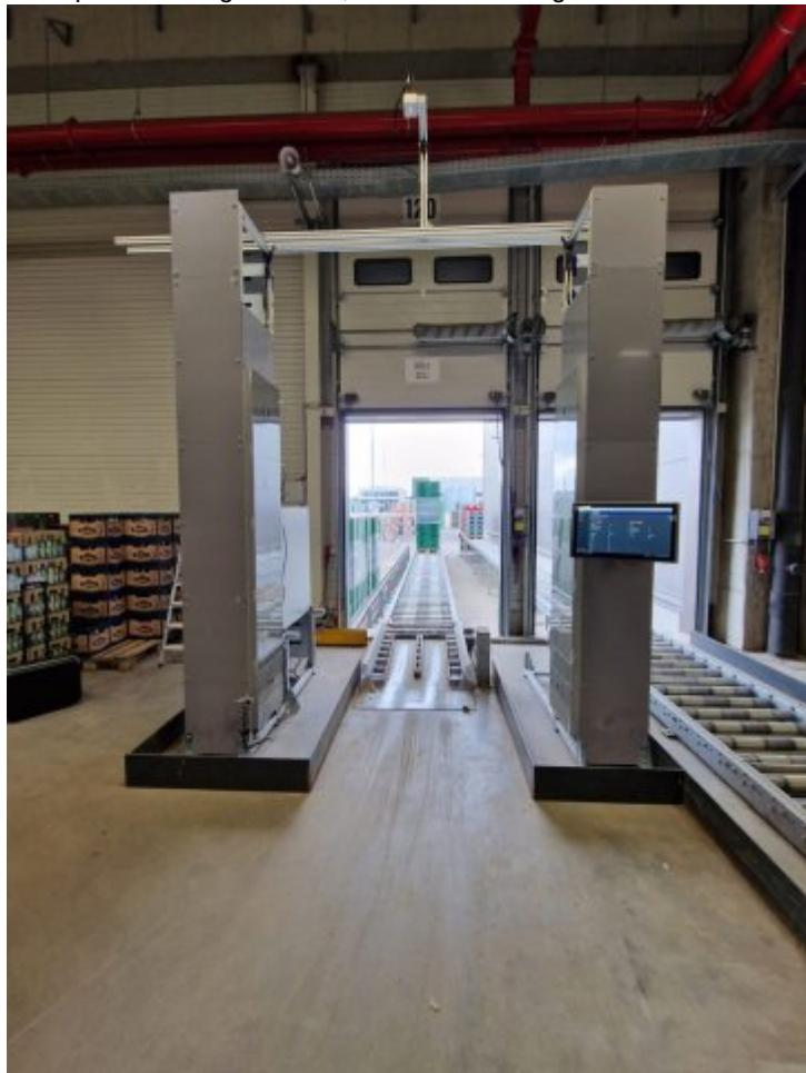
Der Scanner erfasst in Sekundenschnelle genau die Anzahl der Ladungsträger (Bild: Invisium).
