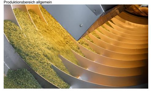
Sterilisieren, Rösten, Trocknen, Coaten und Vorratsschutz mittels Infrarotlicht-Behandlung (Bild: Kreyenborg).
