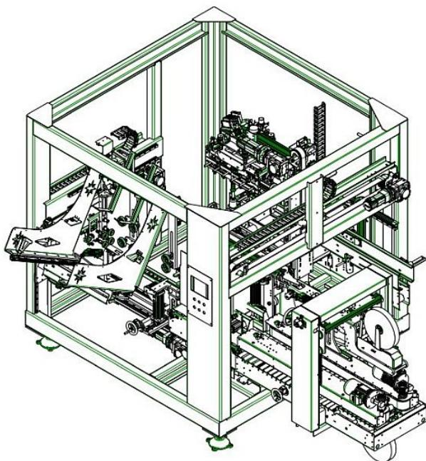
Der Verpackungs-Monoblock vereint Kartonaufrichten, Flascheneinpacken und Kartonverschließen in einer kompakten Maschine (Bild: Clemens).
