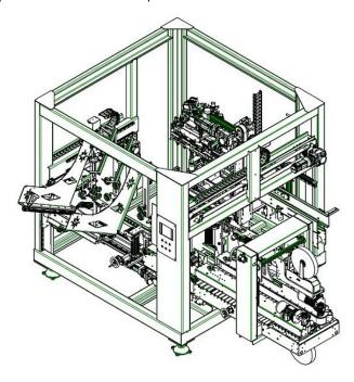
Der Verpackungs-Monoblock vereint Kartonaufrichten, Flascheneinpacken und Kartonverschließen in einer kompakten Maschine (Bild: Clemens).
