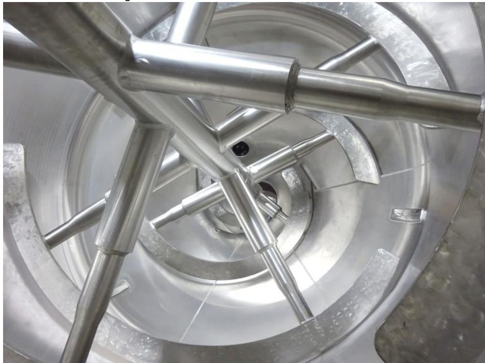
Blick in den Prozessreaktor des Zentralwellenkochers/-Alkalisierers (Bild: Bolz-Summix).
