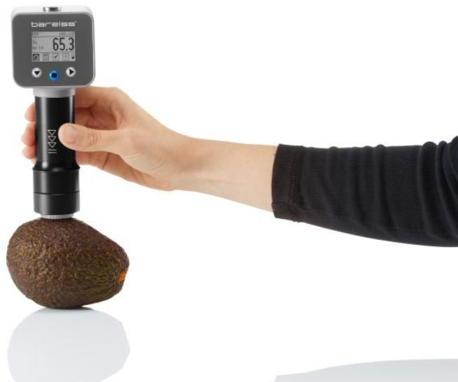
Das Durometer kann die Festigkeit des Avocado-Fruchtfleisches im essbaren Bereich sehr präzise messen (Bild: Bareiss).
