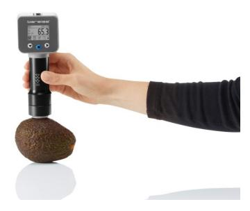
Das Durometer kann die Festigkeit des Avocado-Fruchtfleisches im essbaren Bereich sehr präzise messen (Bild: Bareiss).
