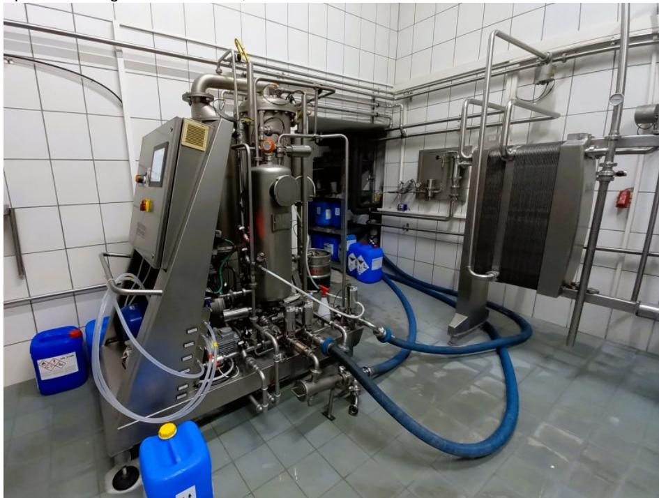
Crossflow-Filter mit Keramikmembranen im praktischen Einsatz (Bild: Atlantic C).
