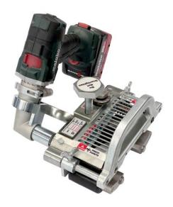
Dank seines elektrischen Antriebs entfernt der Bandhobel die obere Banddecke schneller und effizienter als manuelle Geräte (Bild: Flexco).
