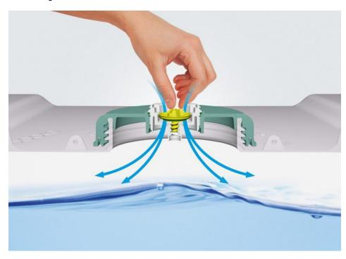
Der »FC/CC«-Stopfen dient der schnellen und sicheren Belüftung der IBC bei der Entnahme. Mit dem »Breather«-System lassen sich IBC entleeren, ohne die Schraubkappe zu öffnen (Bild: Schütz).
