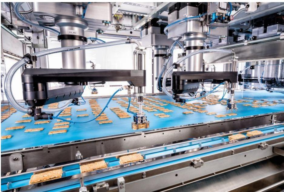
Pick-and-place-Roboter stapeln Produkte in allen möglichen Varianten, bevor sie verpackt werden (Bild: Schubert).
