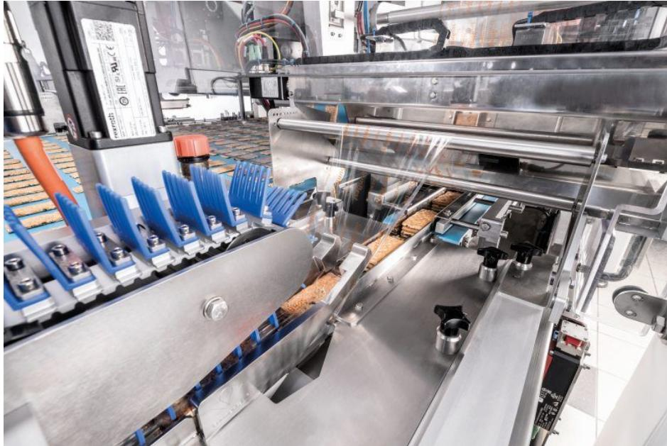
Die vorgestapelten Produkte, hier Kekse, werden der Schlauchbeutelmaschine zugeführt. Die Verpackungsfolie ist dabei frei wählbar und leicht zu wechseln (Bild: Schubert).
