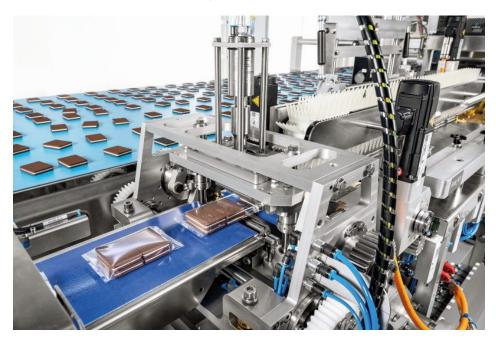
Durch die Ultraschalltechnologie wird der Verpackungsprozess in der Schlauchbeutelmaschine noch flexibler. Die Ultraschalleinheit kann mit wenigen Handgriffen entnommen und zum Beispiel mit einer rotierenden fliegenden Quersiegeleinheit zum Heißsiegeln getauscht werden (Bild: Schubert).
