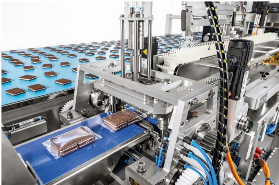
Durch die Ultraschalltechnologie wird der Verpackungsprozess in der Schlauchbeutelmaschine noch flexibler. Die Ultraschalleinheit kann mit wenigen Handgriffen entnommen und zum Beispiel mit einer rotierenden fliegenden Quersiegeleinheit zum Heißsiegeln getauscht werden (Bild: Schubert).
