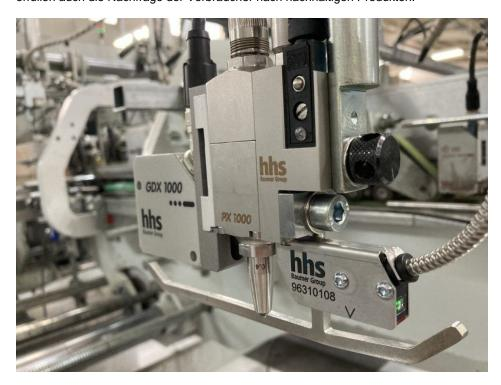
Die neuen Klebstoffauftragsventile und der neue Sensor haben die Präzision des Klebstoffauftrags und die Klebstoffüberwachung stark verbessert (Bild: Baumer hhs).
