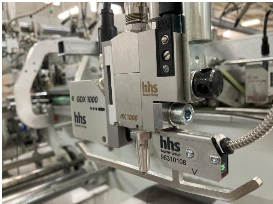
Die neuen Klebstoffauftragsventile und der neue Sensor haben die Präzision des Klebstoffauftrags und die Klebstoffüberwachung stark verbessert (Bild: Baumer hhs).
