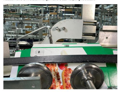
Mit der »Side Seam Gluing Solution« von Baumer hhs wird das Leimrad durch einen Düsenauftrag ersetzt. Das ermöglicht Klebstoffeinsparungen von 50 Prozent (Bild: Baumer hhs).
