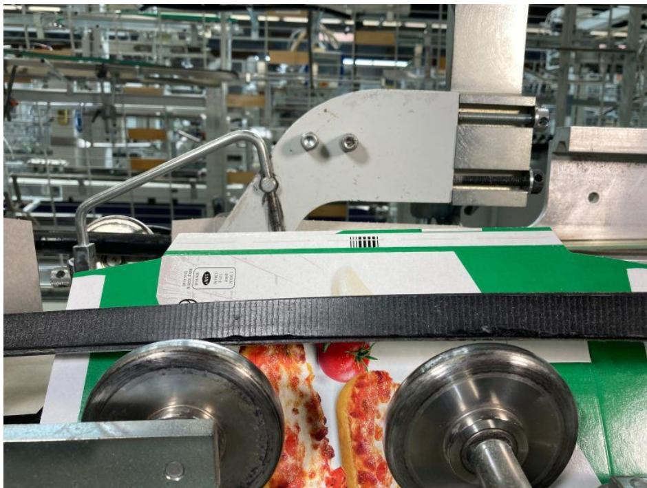
Mit der »Side Seam Gluing Solution« von Baumer hhs wird das Leimrad durch einen Düsenauftrag ersetzt. Das ermöglicht Klebstoffeinsparungen von 50 Prozent (Bild: Baumer hhs).
