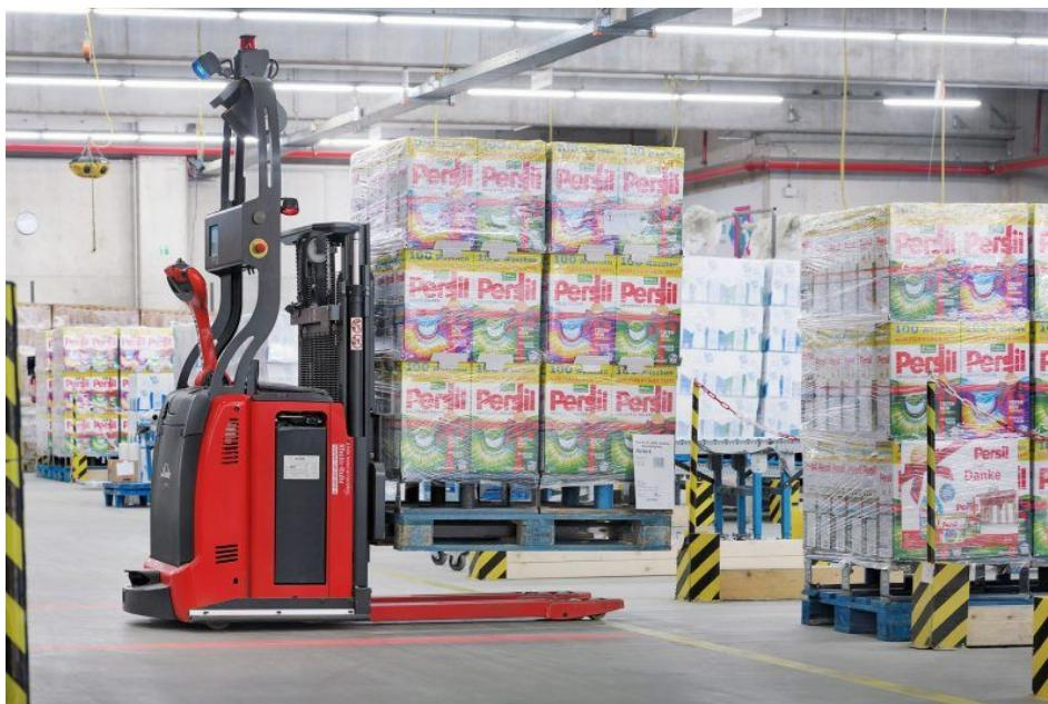
Fünf Hochhubwagen übernehmen autonom den Transport der bestückten Displays (Bild: Linde MH).
