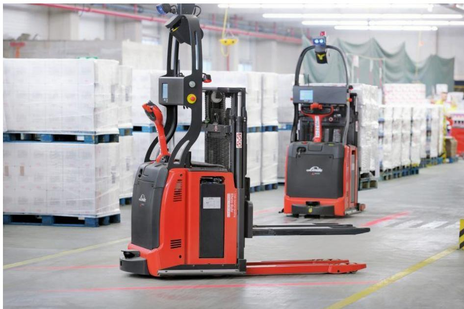
Die Hochhubwagen wickeln den Streckentransport der fertig veredelten Ware zur Stretchmaschine autonom ab. So konnte das bisher dafür verantwortliche Personal für die Schichtleitung weiterqualifiziert und an anderer Stelle im Unternehmen eingesetzt werden (Bild: Linde MH).
