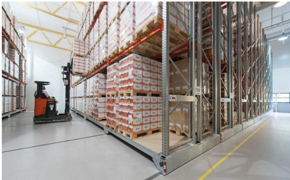
Das Schwerlast-Verschieberegalsystem ermöglicht die effizientere Nutzung vorhandener Lagerfläche (Bild: Dexion).
