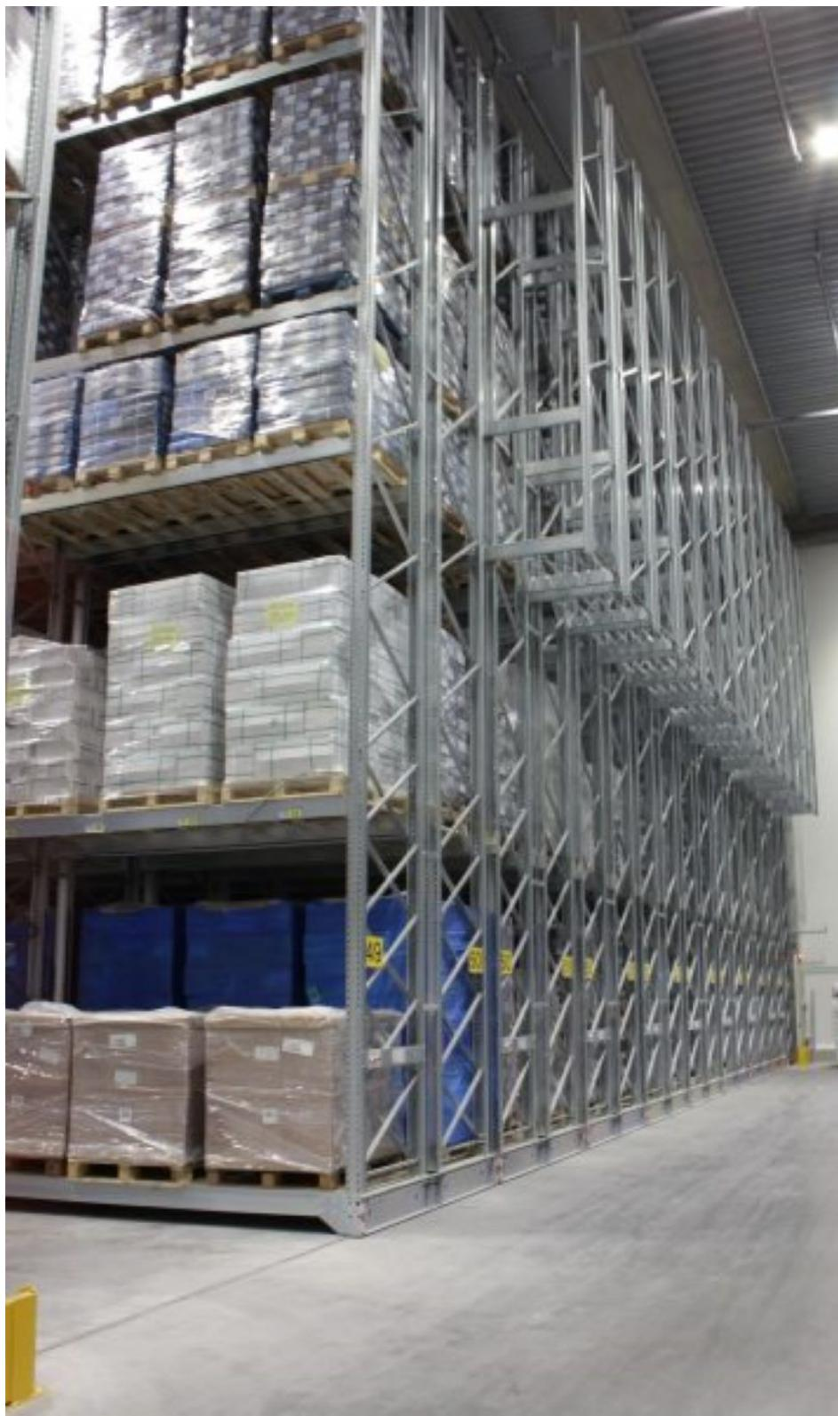
Bis zu 50 Prozent Flächeneinsparung sind im Vergleich zu herkömmlichen Palettenregalen möglich (Bild: Dexion).
