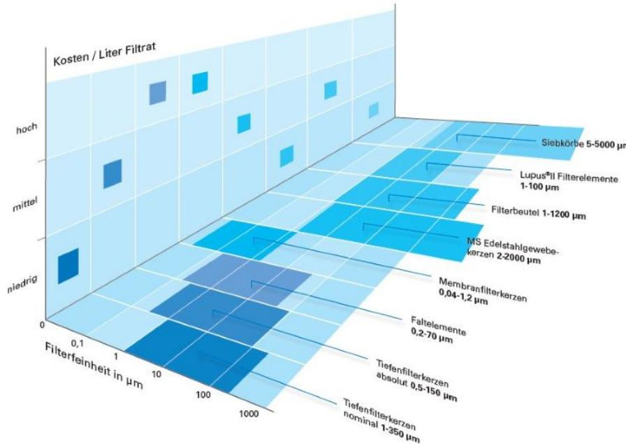
Die Grafik zeigt typische Filterelemente im Vergleich zu den verfügbaren Filterfeinheiten und den zu erwartenden Kosten je Liter Filtrat. Weitere Auswahlkriterien sind chemische und thermische Beständigkeit sowie die charakteristische Filtereigenschaft des Filtermediums der jeweiligen Tiefen- und Oberflächenfilter (Bild: Wolftechnik).
