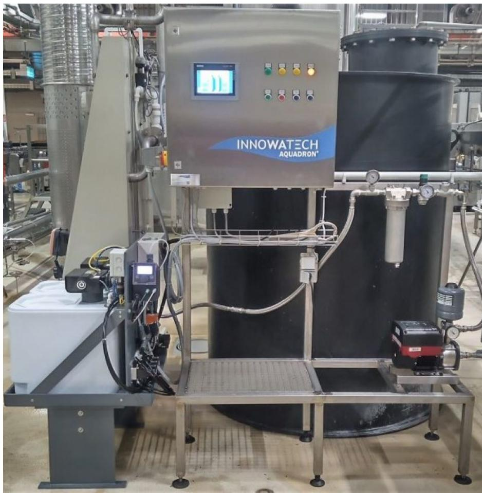
Einsatzbeispiel in der AfG-Produktion: Die Anlage produziert das Desinfektionsmittel für die permanente Desinfektion während der Abfüllung. Dadurch reduziert sich der Einsatz von Kaltsterilisationsmitteln (Bild: Innowatech).
