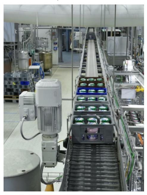
Die gefüllten 6er-Stiegen mit 500-Gramm-Joghurtgläsern werden über ein Förderband zur Logistik weitergeleitet. Der dezentrale Antrieb »Movimot performance« von SEW-Eurodrive – vorn im Bild – sorgt für den kraftvollen Antrieb des vorgelagerten
