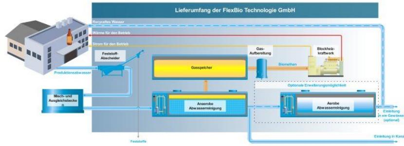
Flussdiagramm der Abwasserbehandlung mit Misch- und Ausgleichsbecken, Abwasserbehandlung, Gasaufbereitung, -speicherung und -verwertung sowie Infrastruktur (Bild: FlexBio).
