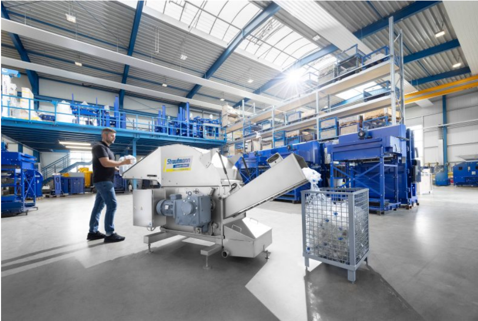
»LiquiDrainer« für die Entleerung ganzer Getränkegebinde (Bild: Strautmann).
