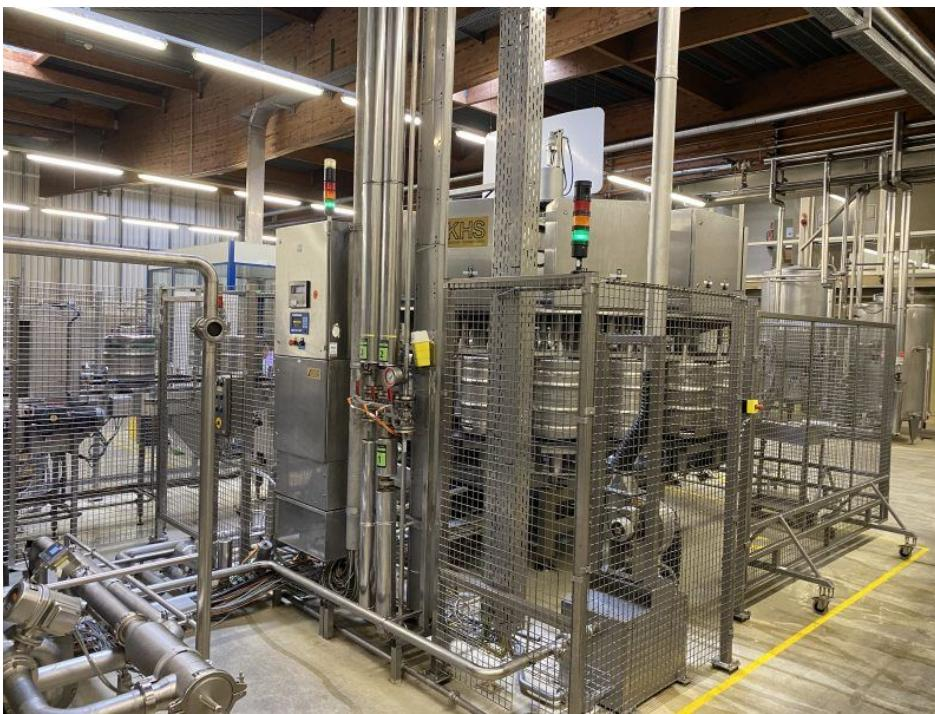
Ein Teil der Schutzwand lässt sich ohne großen Aufwand entfernen, damit einmal im Jahr für Servicetätigkeiten mit dem Stapler zu dem in der Mitte platzierten Medienverteiler vorgedrungen werden kann (Bild: Pilz).
