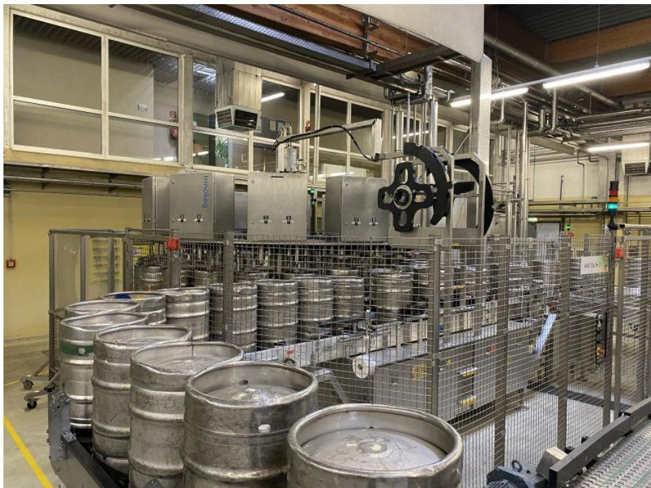
Bei dieser seit 1993 in Betrieb stehenden Anlage wurden unter anderem die Eingriffsmöglichkeiten in die Maschine neu bewertet und validiert (Bild: Pilz).
