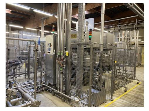
Ein Teil der Schutzwand lässt sich ohne großen Aufwand entfernen, damit einmal im Jahr für Servicetätigkeiten mit dem Stapler zu dem in der Mitte platzierten Medienverteiler vorgedrungen werden kann (Bild: Pilz).
