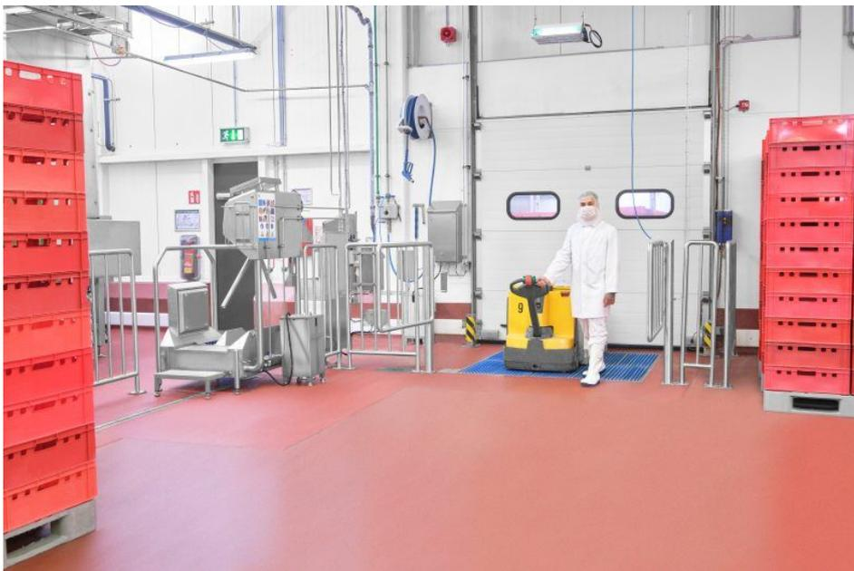
Boden-Hygienschleusen beseitigen zuverlässig Schmutz, Staub und Verunreinigungen, die durch Räder, Reifen und Sohlen von Flurförderzeugen oder Mitarbeitenden in die Gebäude gelangen (Bild: Mohn).
