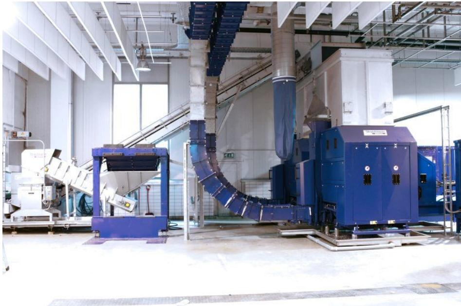
Die Brikettierpresse, hier im Einsatz bei Teinacher, verdichtet zuverlässig Verpackungen und sorgt so für die Reduzierung des Wertstoffvolumens (Bild: Strautmann).
