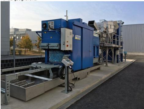
Der Entwässerer »LiquiDrainer« und die Ballenpresse »BaleTainer« können verbunden werden, um die entleerten Gebinde direkt zu verdichten (Bild: Strautmann).
