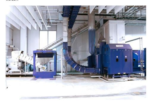
Die Brikettierpresse, hier im Einsatz bei Teinacher, verdichtet zuverlässig Verpackungen und sorgt so für die Reduzierung des Wertstoffvolumens (Bild: Strautmann).
