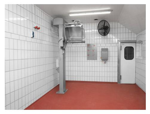
Hebe-Kippvorrichtung in Kippposition (Bild: Mohn).
