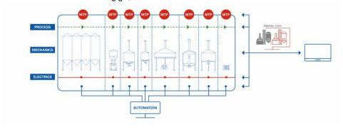
Der digitale Zwilling ist eine cloudbasierte Datenplattform, in der alle Daten der MTPs hinterlegt und abrufbar sind (Bild: Ziemann Holvrieka).
