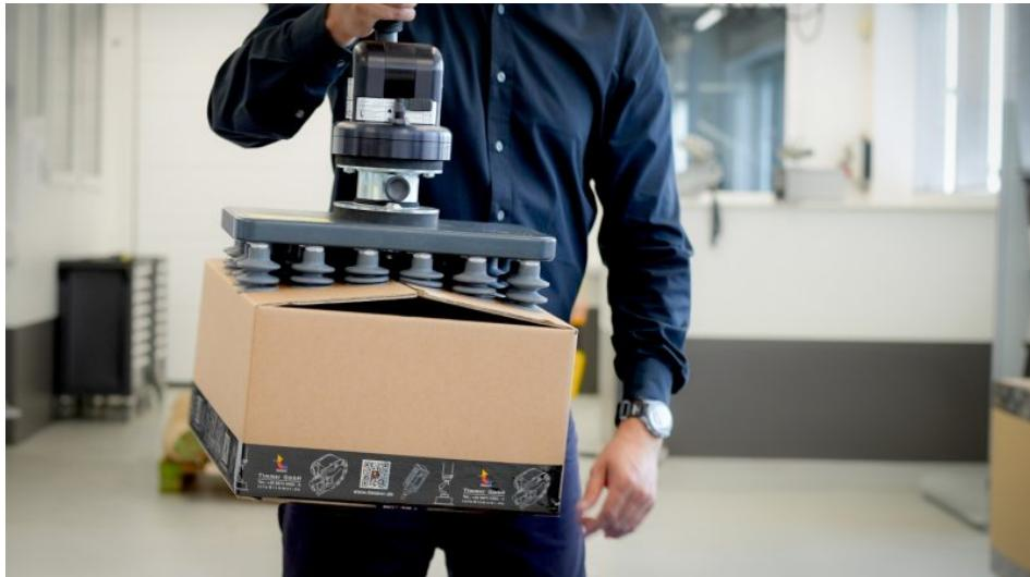
Der neue Saugfuß kann auch an unebenen Flächen wie unverschlossenen Kartons eingesetzt werden (Bild: Timmer).
