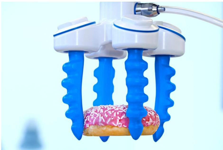
Der menschlichen Hand nachempfunden, setzt der Fingergreifer unterschiedlich geformte Waren sicher an der Zielposition ab (Bild: Schmalz).
