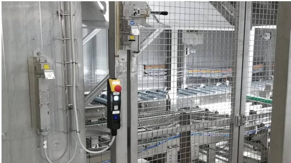
Die Produktionsanlagen bei Iglo in Reken sind mit dem Schlüsseltransfersystem aus Edelstahl abgesichert (Bild: Dold).
