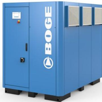
Der neue Turbokompressor ist kleiner als ein ölfreier Schraubenkompressor bei vergleichbarer Leistung (Bild: Boge).
