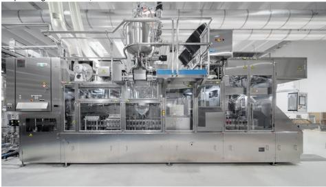
Die ESL-Abfüllmaschine verfügt über sehr hohe Hygienestandards, wodurch frische Produkte bis zu 60 Tagen haltbar werden (Bild: Elopak).
