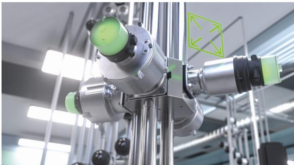
Die Membranventile lassen sich wegen des geringeren Totraums schneller reinigen als herkömmliche Ringsysteme (Bild: Bürkert).
