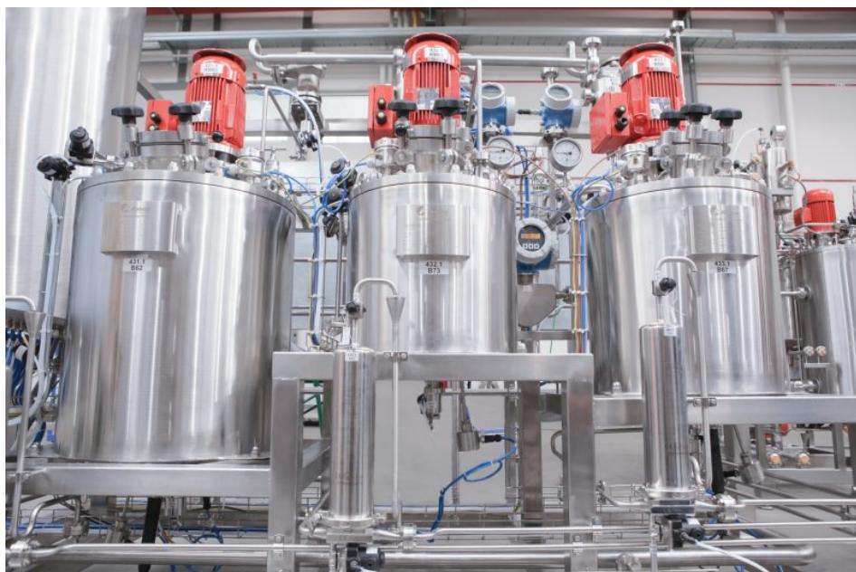
Fermenter ermöglichen die kontrollierte Vermehrung von Mikroorganismen und die Produktion von biochemischen Produkten mittels Fermentation (Bild: Ruland).
