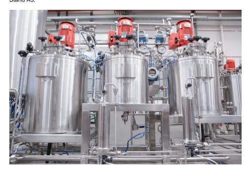
Fermenter ermöglichen die kontrollierte Vermehrung von Mikroorganismen und die Produktion von biochemischen Produkten mittels Fermentation (Bild: Ruland).
