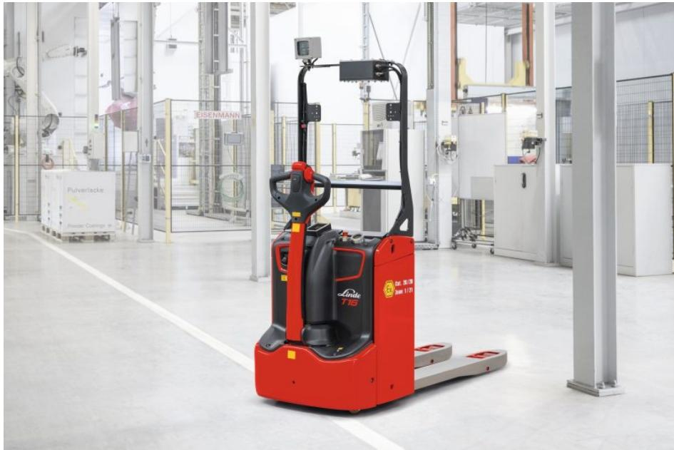
Das kompakte Mitgängergerät ist für die ATEX-Zonen 1/21 und 2/22 geeignet (Bild: Linde Material Handling).
