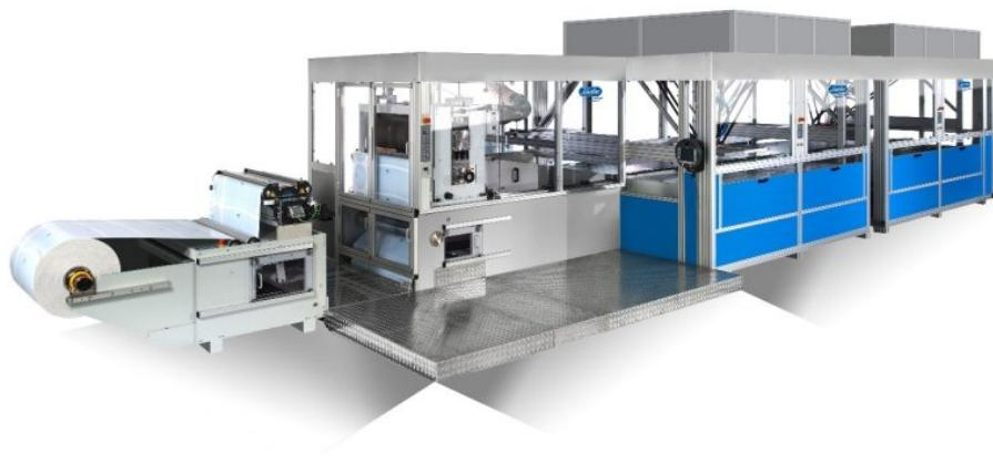
Die leistungsfähige Rotationsschneid- und Stanzmaschine arbeitet besonders energieeffizient (Bild: Schobertechnologies).
