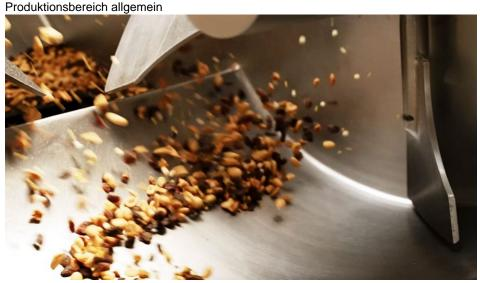
Das neue System sorgt für die vollständige Entleerung und Reinigung von Horizontalmischern (Bild: Gericke).
