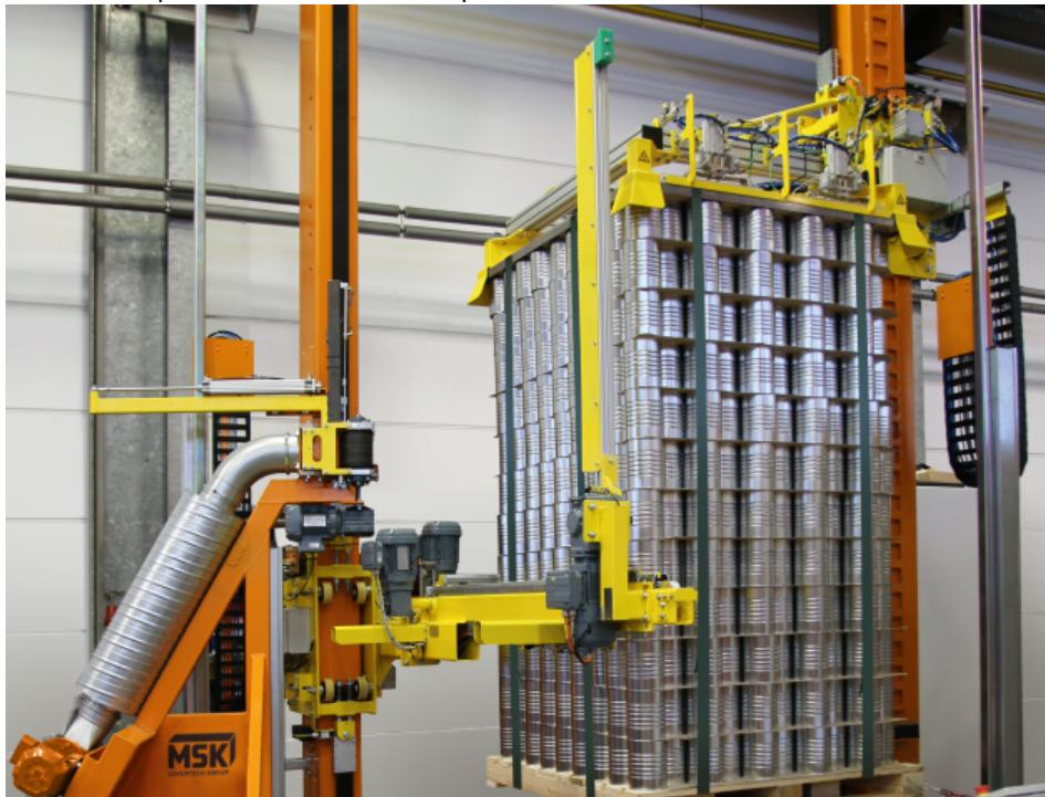
Der Destrapper bietet eine hohe Leistung beim Entfernen von Umreifungsbändern (Bild: MSK).
