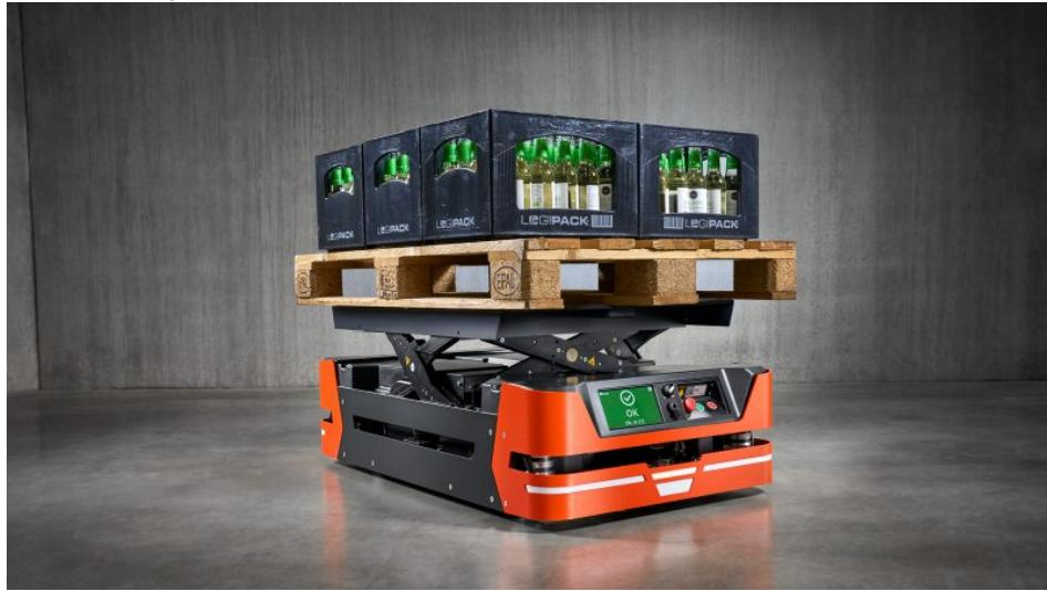
Das fahrerlose Transportsystem ist auch mit einem scherengelagerten Hubtisch erhältlich (Bild: Safelog).
