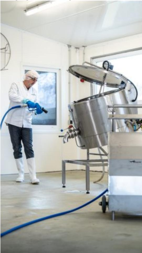
Mit einem einfachen Dreh an der Düse wird das Niederdruck-Schaumgerät von Sprühen auf Schäumen umgestellt (Bild: JD5).
