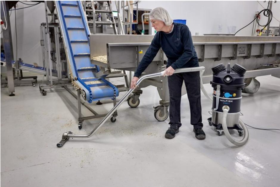
Die kompakten Sauger sind für den Einsatz in explosionsgefährdeten Umgebungen konzipiert (Bild: Nilfisk).
