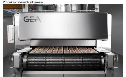
Vormontierte Backofenmodule verringern die Installationszeit vor Ort (Bild: GEA).
