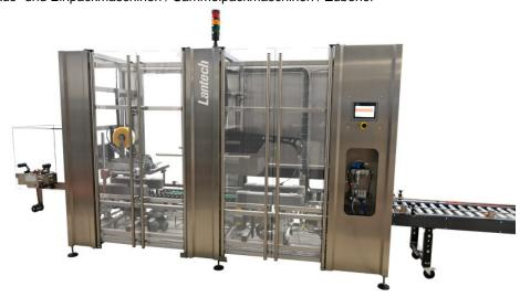
Der neue Kartonverschließer verarbeitet wechselnde Formate mit hoher Leistung (Bild: Lantech).
