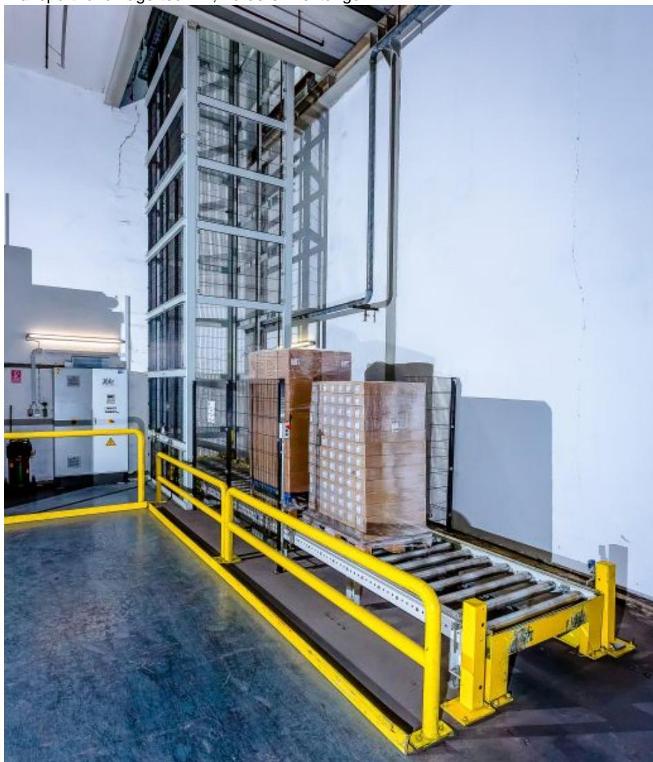
Neue Flächen lassen sich durch Zwischenebenen erschließen, die der Vertikalförderer
