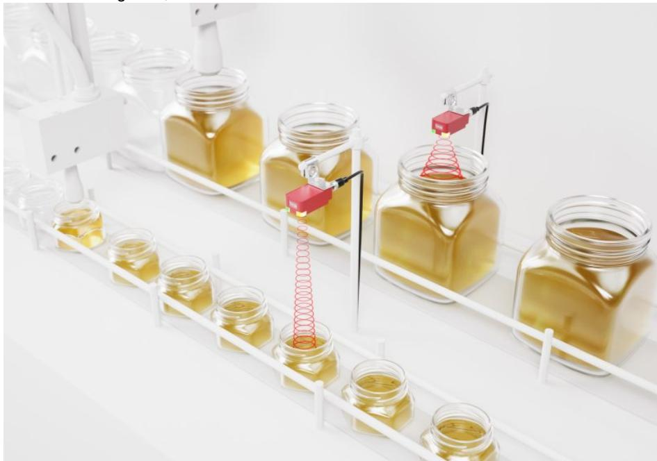
Diese Ultraschalltaster sind mit einer einstellbaren Schallkeule ausgestattet. So können z. B. Füllstände durch unterschiedlich große Behälteröffnungen überwacht werden (Bild: Leuze).
