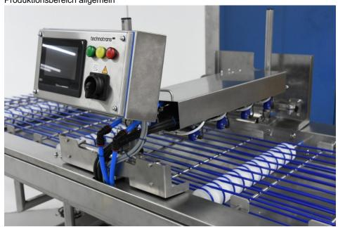
Im Sprühsystem arbeiten druckluftfreie, hochfrequente Ventile, die eine Nebelbildung verhindern und ein präzises, homogenes Sprühbild erzeugen (Bild: technotrans).
