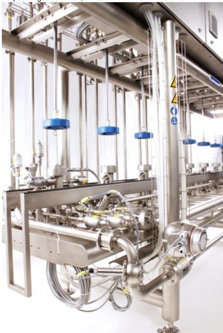
Beispiel für eine Keg-Abfüllanlage im Hygienedesign (Bild: m+f Keg-Technik).
