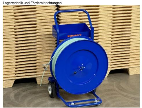
Der Abrollwagen für Umreifungsbänder ist mit vier Rädern besonders manövrierfähig (Bild: Kemapack).
