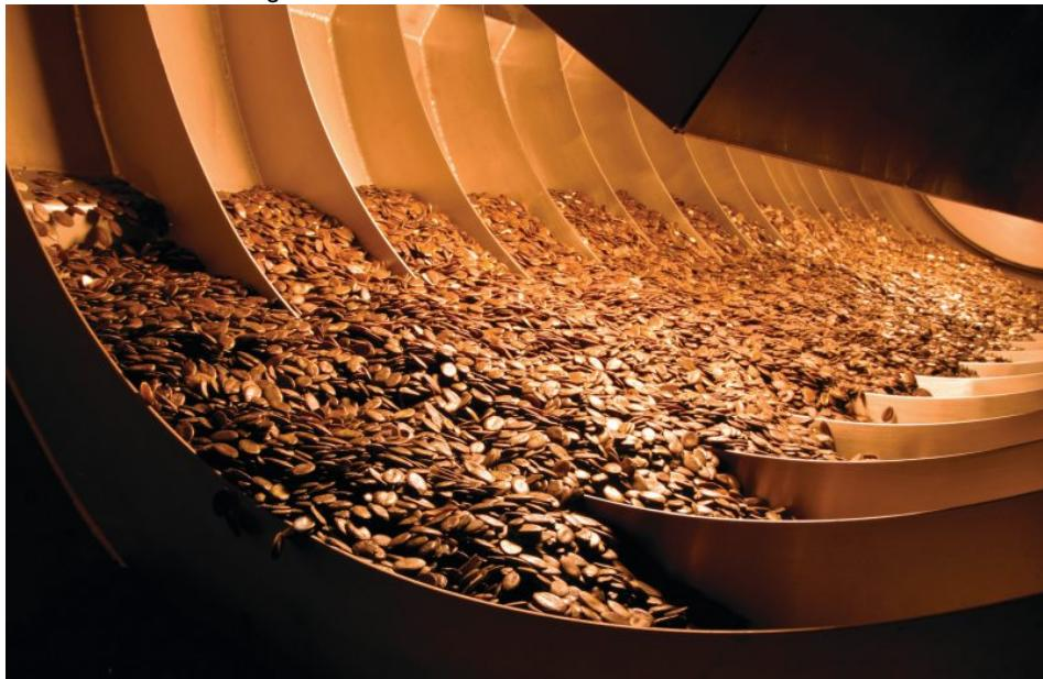
Das Infrarotlicht erwärmt die zu behandelnden Produkte in nur wenigen Minuten von innen nach außen (Bild: Kreyenborg).
