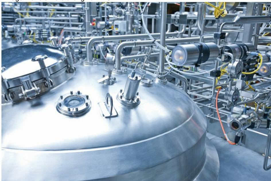
Die Systeme zur Druckregelung reagieren auf Änderungen von Temperatur und Füllmenge sowie auf chemische Reaktionen im Tank (Bild: Bürkert).
