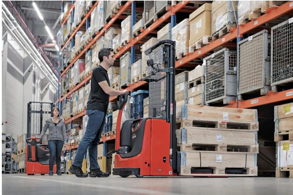
Die neuen Elektro-Hochhubwagen sind besonders kompakte Mitgängerfahrzeuge im Traglastbereich bis 1,6 t (Bild: Linde MH).
