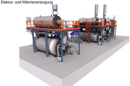
Die Thermalölerhitzer verfügen über eine Nettoheizleistung von 3 x 3700 kW (Bild: Intec Engineering).
