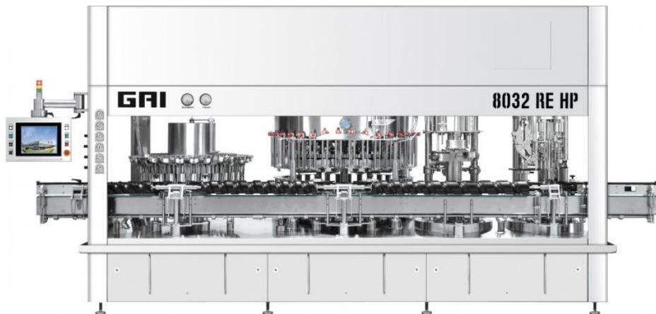
Beispiel für einen vollautomatischen Monoblock zum Rinsen, Füllen mit elektropneumatischen Füllventilen und Verschließen (Bild: GAI/Clemens).
