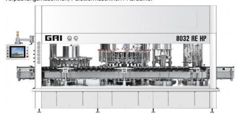
Beispiel für einen vollautomatischen Monoblock zum Rinsen, Füllen mit elektropneumatischen Füllventilen und Verschließen (Bild: GAI/Clemens).
